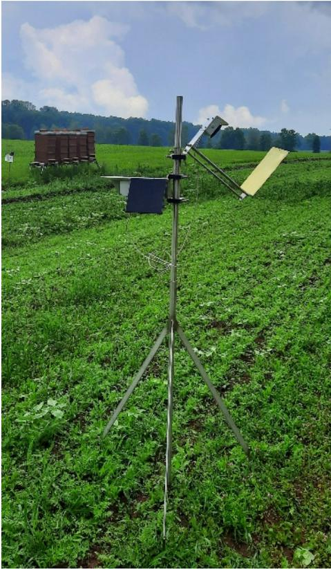
Abbildung 5: Insektenkamera im Bereich der Triesdorfer Beetle Bank
